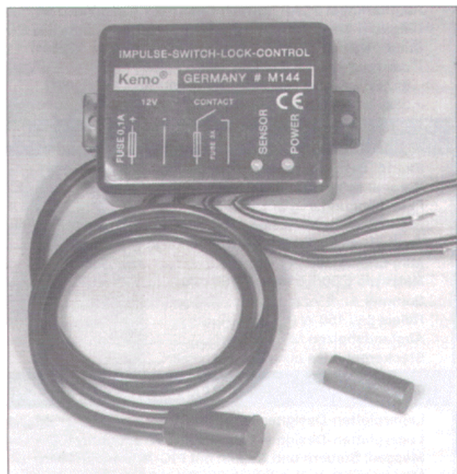
Bild 2: Sobald sich der kleine Magnet (rechts) dem Reed-Kontakt (vorn Mitte) nähert, zieht das Relais kurz an.
